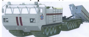
15. Пожарно - спасательная машина повышенной проходимости модульного принципа компоновки ДТП – ЗПСА (сменные модули контейнерного типа: пожарно - спасательные, командно - штабные, поисково – спасательные, медицинские,) с погрузочно- разгрузочным механизмом (мультилифт) на базе трансп. ДТ-3ПМ, завода АО «МК «Витязь»
