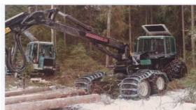
22 Погрузочно-транспортная машина, разработанная и изготовленная финскими машиностроителями Рантапуу, Марку Мякеля, Терратек с использованием узлов и систем серийных моделей тракторов Минского тракторного завода.
