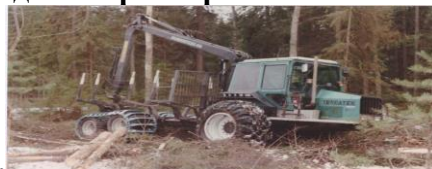
22 Погрузочно-транспортная машина, разработанная и изготовленная финскими машиностроителями Рантапуу, Марку Мякеля, Терратек с использованием узлов и систем серийных моделей тракторов Минского тракторного завода.
