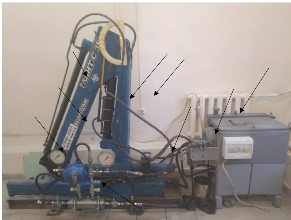
Рисунок 2 – Общий вид стендового гидроманипулятора ЛВ–210 с насосной станцией
