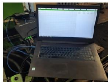
Рисунок 1 – Устройство обработки данных (а) – тензометрическая станция ZET 058, (б) – компьютер для обработки полученных данных
