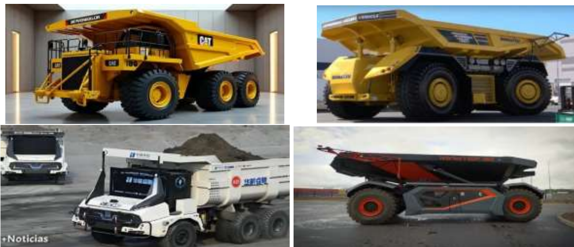
Рисунок 1. Беспилотные карьерные самосвалы: Caterpillar Cat 793F; Komatsu IAHV; Huawei Huaneng Ruichi; КАМАЗ-6559 «Юпитер 30»
