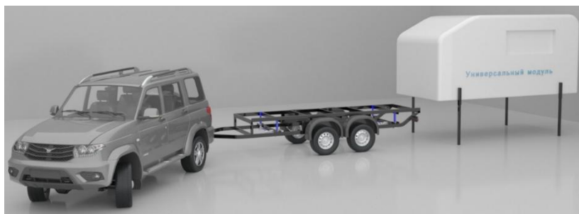
Рисунок 6 – Модель легкового прицепа, оснащенного штатным подъемным механизмом для транспортировки съемных модулей различного назначения.
