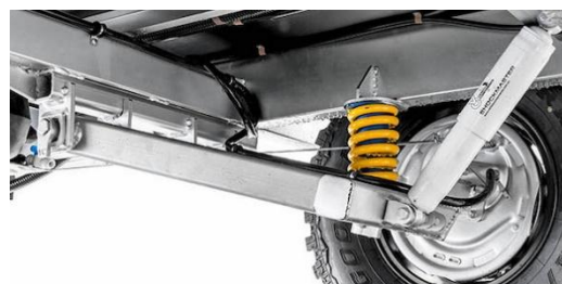
Рисунок 4 – Пружинная зависимая подвеска Figure 4 – Spring dependent suspension
