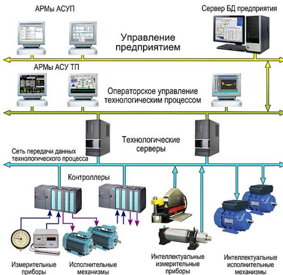
Рисунок 3 – Структурная схема системы автоматизированного управления технологическим процессом непрерывного дозирования компонентов бетонных смесей
