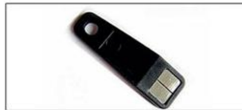
Идентификатор со встроенными пассивными радиоэлементами
