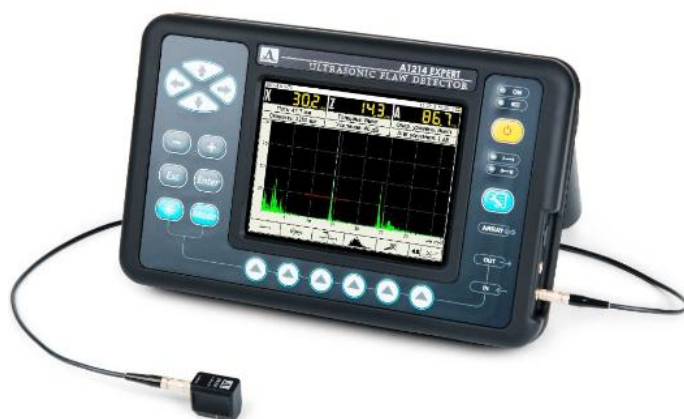
Рисунок 1 – Ультразвуковой дефектоскоп A1214 Expert
