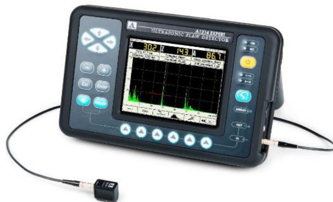
Рисунок 1 – Ультразвуковой дефектоскоп A1214 Expert
