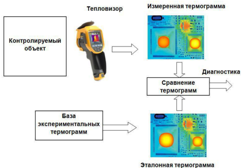
Рисунок 2 – Сравнительная инфракрасная термография
