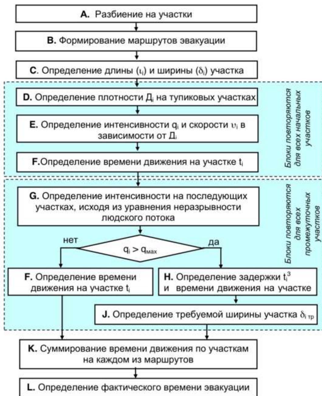
Рисунок 1 – Алгоритм определения расчётного времени эвакуации
