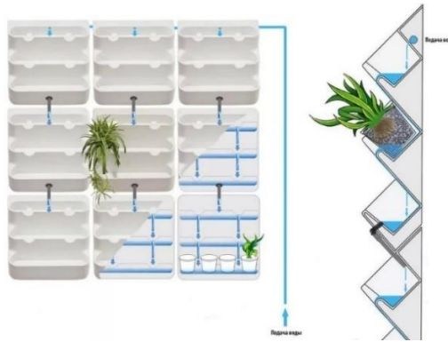
Рисунок 3 – Схема устройства для вертикального озеленения на грунте
