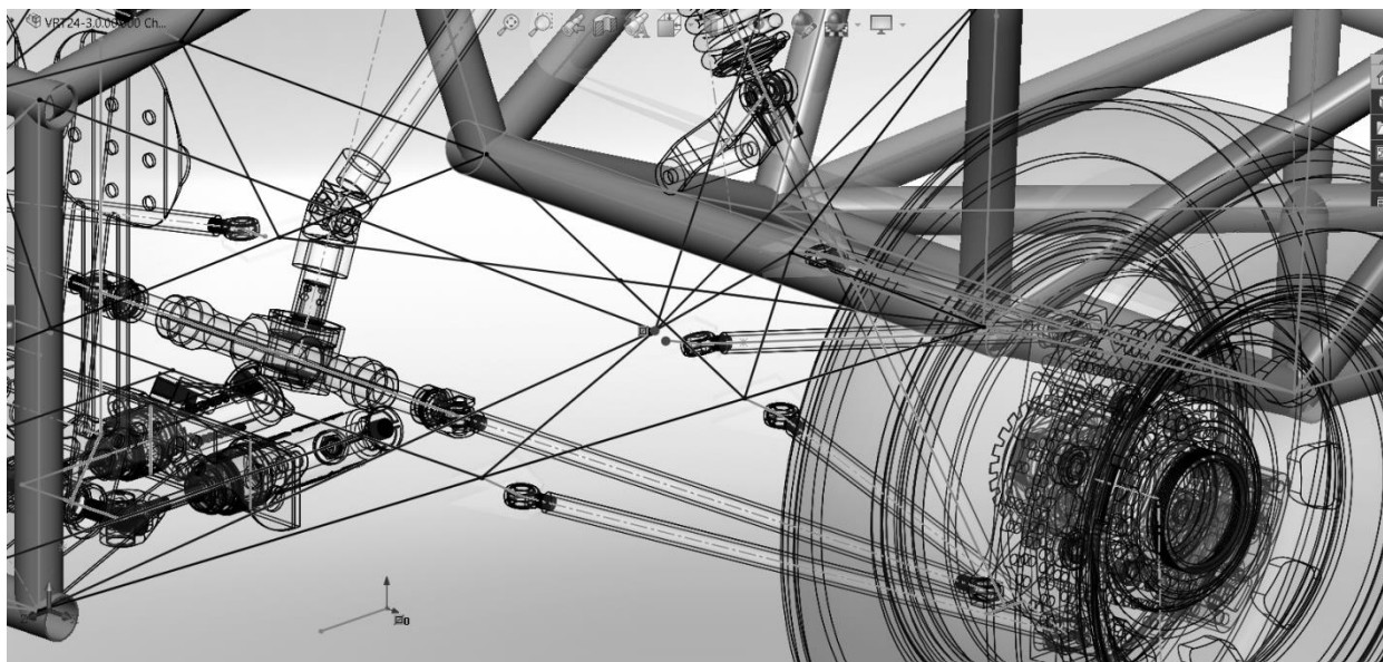
Рисунок 1 – Компоновочный эскиз пространственной рамы с привязкой к рычагу подвески
