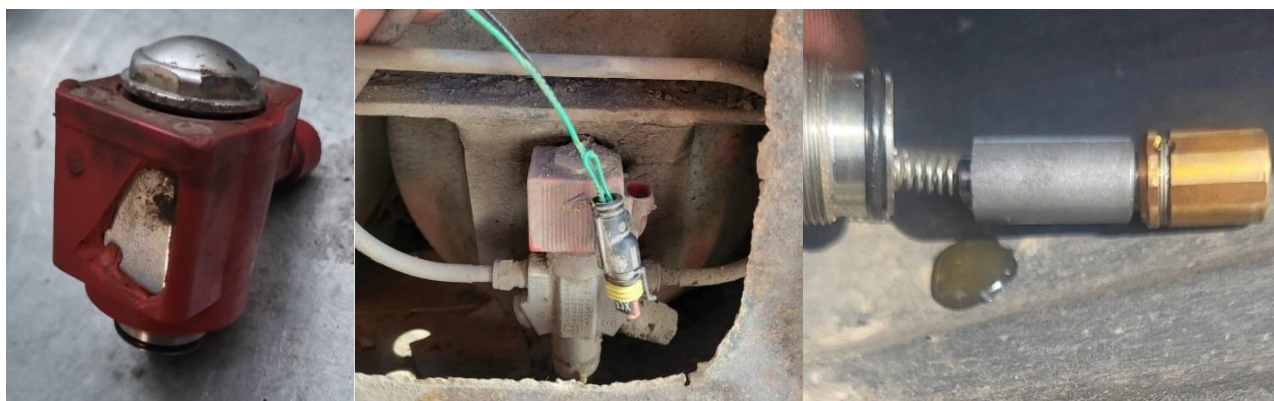
а) разрушение соленоида; б) замыкание штекера питания; в) загрязнение сердечника клапана Рисунок 1 – Неисправности электромагнитного клапана вентиля
