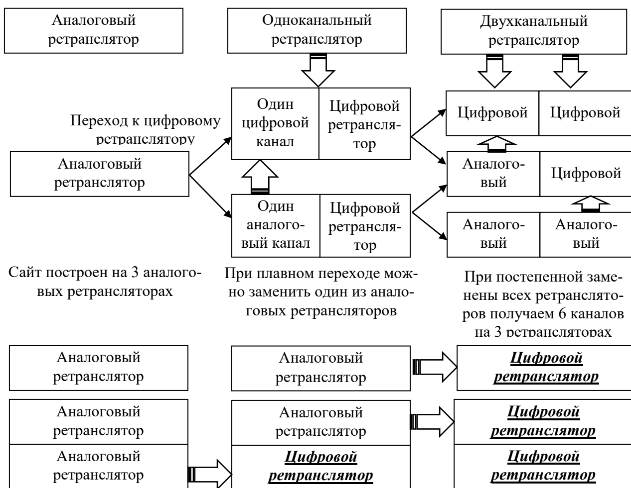
Рисунок 2 – Переход от аналоговой к цифровой системы посредством ретрансляторов
