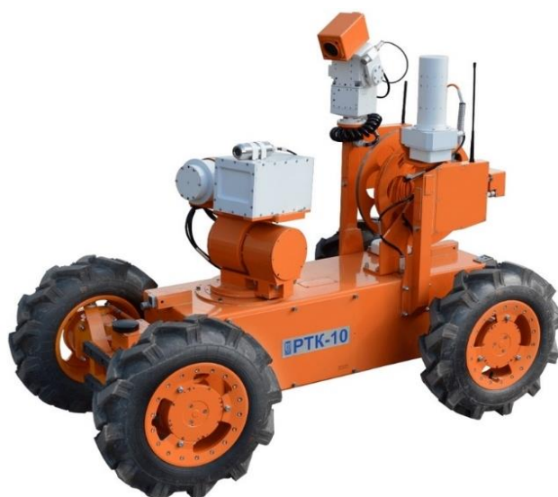
Рисунок 1- Роботизированная платформа с использованием технологии LIDAR
