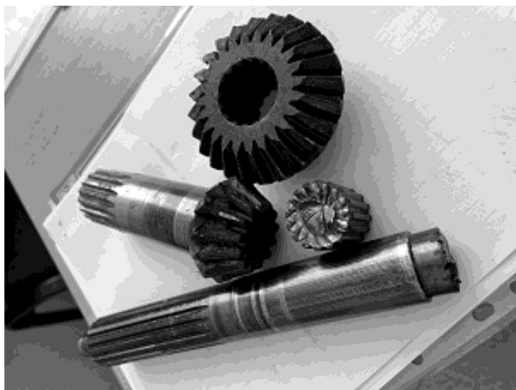
Рисунок 1 – Характер разрушения вершин зубьев ведомой и ведущей шестерен ведущего вала
