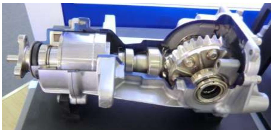
Рисунок 8 – Муфта и главная передача заднего ведущего моста
