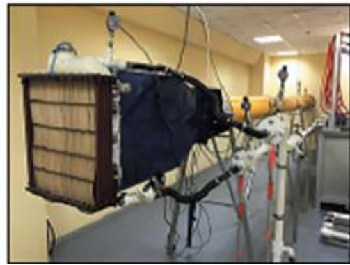
Рисунок 2 – Специальный стенд для испытаний разных конструкций радиаторов
