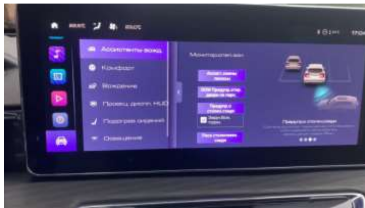
Рисунок 5 – Интерфейс системы мониторинга задней и боковых зон: а – ассистент смены полосы, б – предупреждение открытия двери на парковке, в – предупреждение о столкновении сзади
