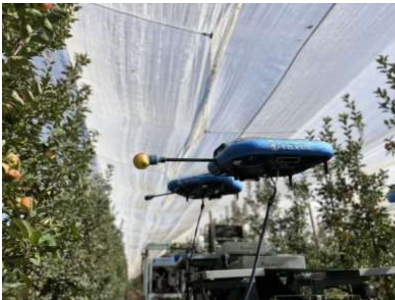
Рисунок 11 – Дрон с присосками для сбора яблок
