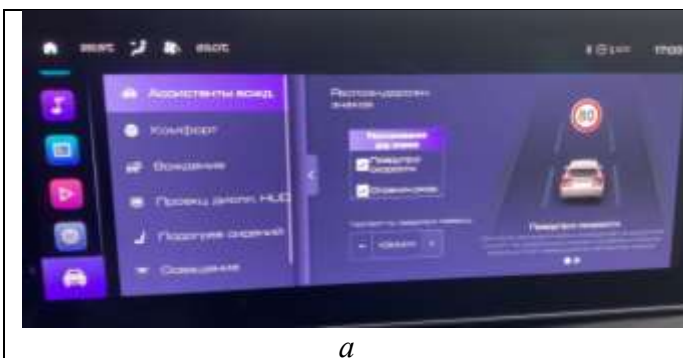
Рисунок 7 – Интерфейс системы идентификации дорожных знаков: а – предупреждение о скорости движения, б – ограничение скорости движения
