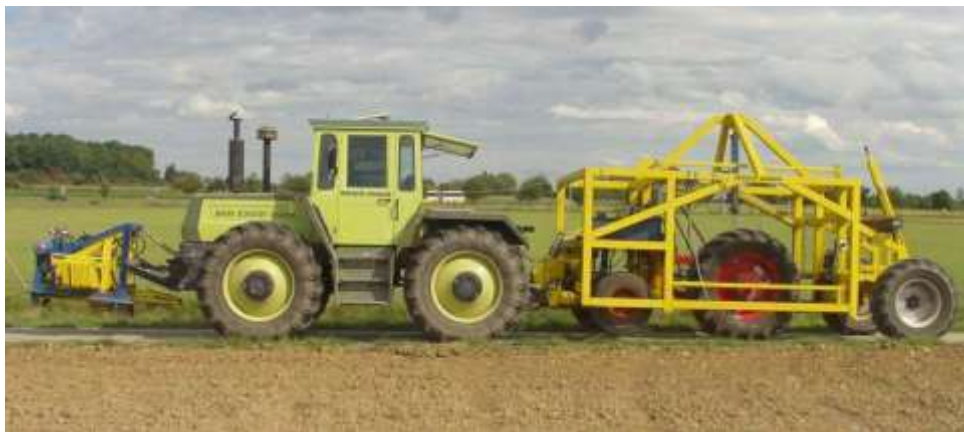
Рисунок 3 – Прицепной шинный тестер для испытаний шин в полевых условиях
