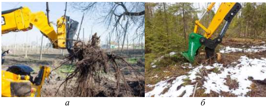
Рисунок 19 – Рычажные корчеватели: а – рычажный корчеватель А.ТОМ Мна базе погрузчика JCB б – рычажный корчеватель КИМ-600, агрегируемый экскаватором Shantui
