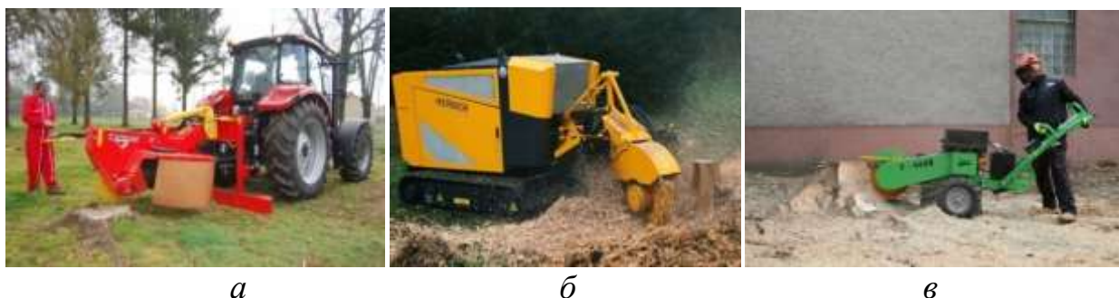
Рисунок 15 – Измельчители пней: а – дисковый измельчитель пней RabaudXYLOCROK T, б – беспилотный дисковый измельчитель пней Herder SCT-550H, в – дисковый измельчитель пней Laski F460/27 E
