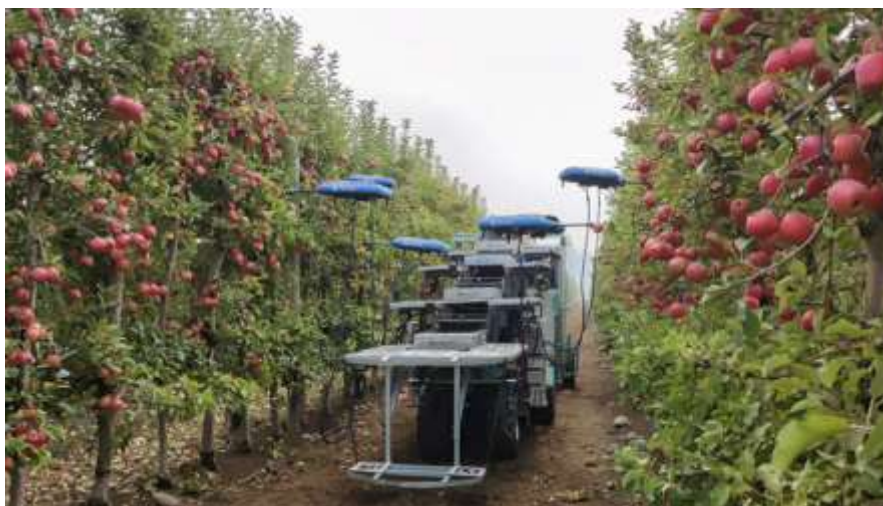
Рисунок 10 – Платформа с роем дронов для сбора плодов яблок
