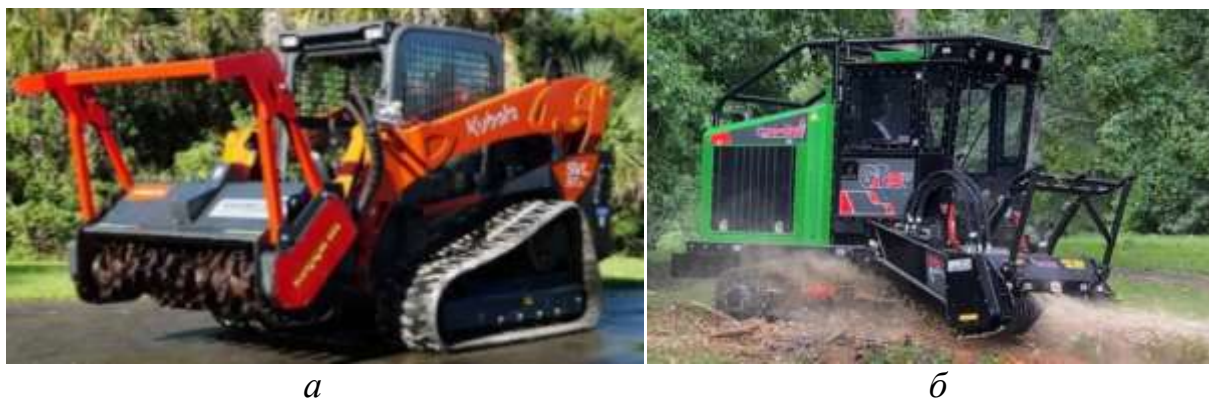
Рисунок 10 – Мульчеры: а – мульчер SEPPi MINIFORST cl на базе погрузчика Kubota SVL 97-z, б – самоходный мульчер Gyro-Trac GT-350
