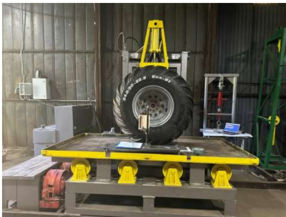
Рисунок 7 – Универсальный стенд для испытаний шин сверхнизкого давления
