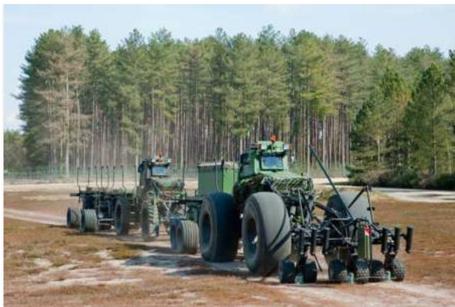
Рисунок 2 – Технология разминирования SOUVIM II
