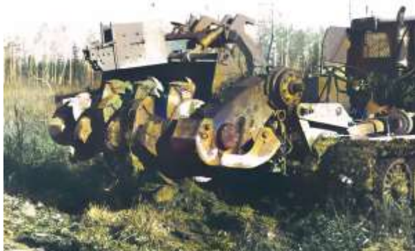
Рисунок 8 – Машина для дробления пней МДП – 1,5:
