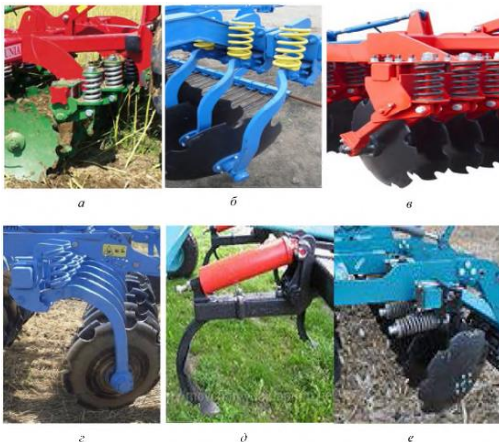
Рисунок 1 – Пружинно-гидравлические предохранители рабочих органов дисковых орудий: а - навесного почвообрабатывающего агрегата ARES TWIX; б - полунавесного дискатора АГЛ-4; в - прицепной бороны БДТ-2,5*2; г - полунавесной бороны АГЛ-6; д - бороны с чизельной приставкой БДВП-4,2-0,1; е - мульчирующей бороны «Вектор» В-350»
