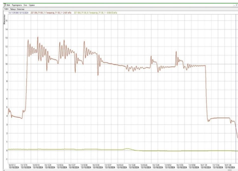
Рисунок 8. Экспериментальные осциллограммы давления рабочей жидкости в гидроцилиндре подъема стрелы с подключением демпфера
