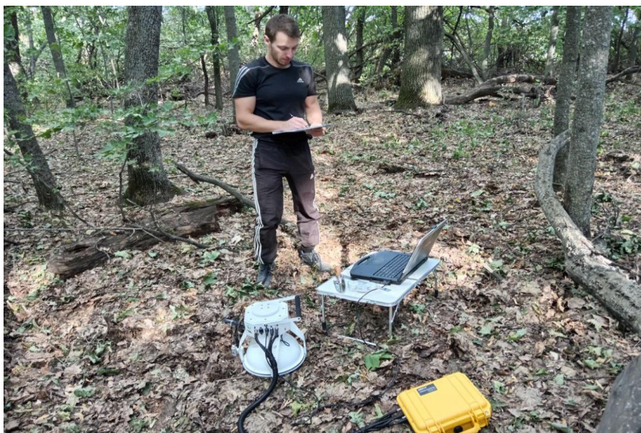
Рисунок 1 – Измерение потока углекислого газа на участке полезащитной лесополосы
