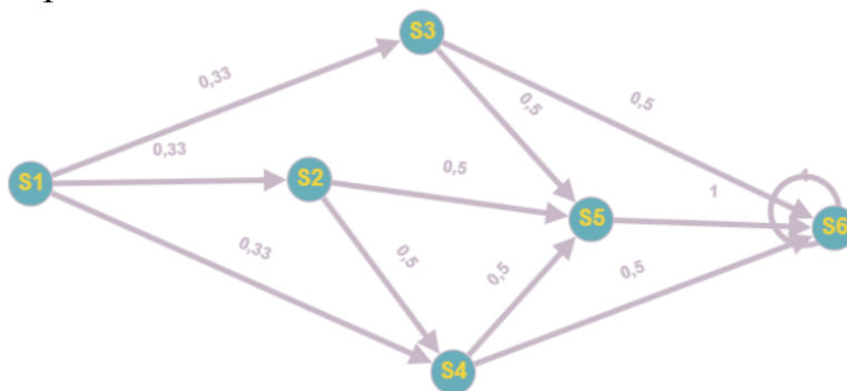
Рисунок 1 – Пример графа переходов состояний блокчейн-системы
