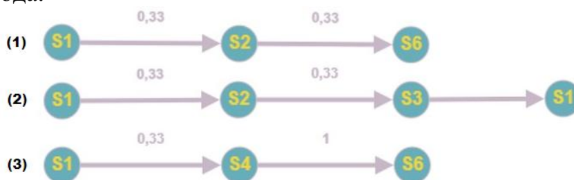
Рисунок 4 – Наиболее вероятные цепочки переходов состояний при реализации дефекта повторного входа
