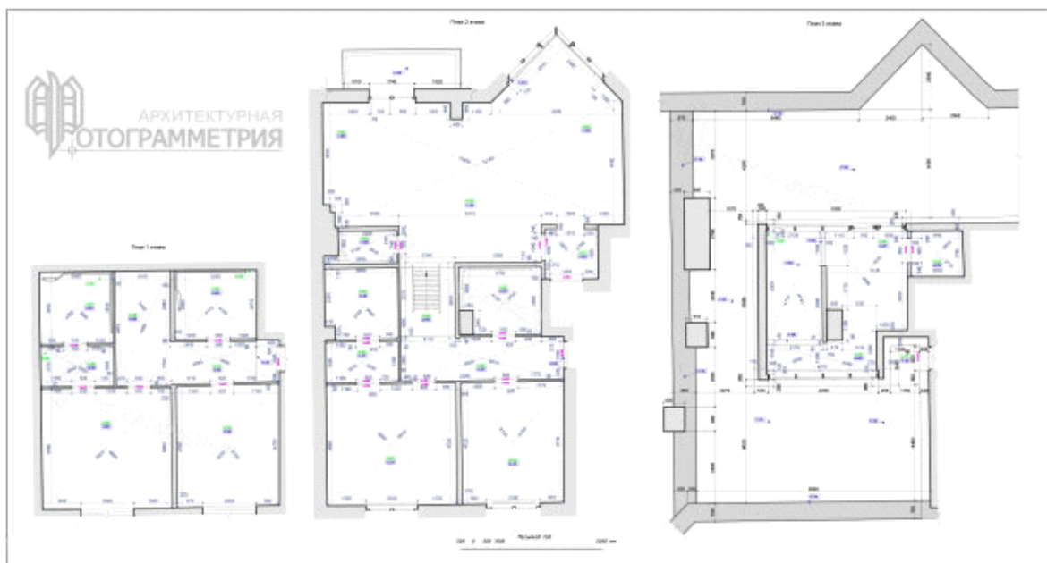
Рисунок 2 - Обмерные чертежи: план каждого уровня квартиры
