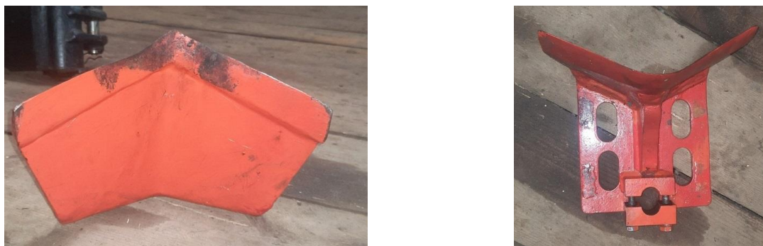
Рисунок 2 – Стационарный нож харвестерной головки компании Silvatec
