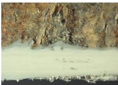
Рисунок – 9 Механическое соединение (адгезия) полимера и основы
