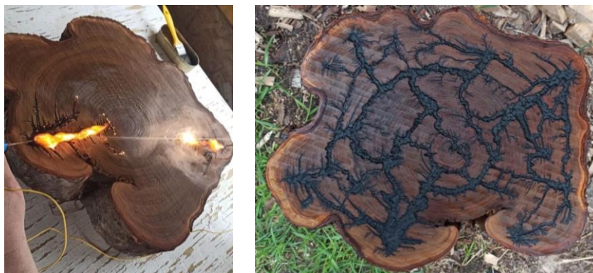
Рисунок 2 – Выжигание молний Лихтенберга на столешнице
