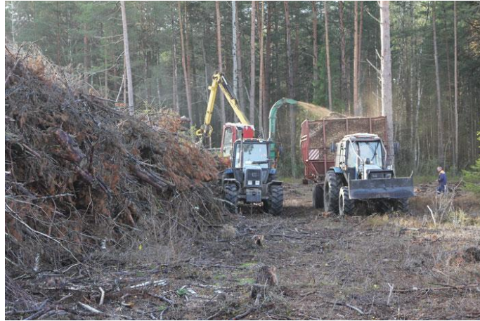
Рисунок 2 – Переработка удалённой растительности на щепу
