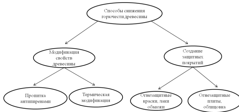
Рисунок 2 – Схема способов снижения горючести древесины
