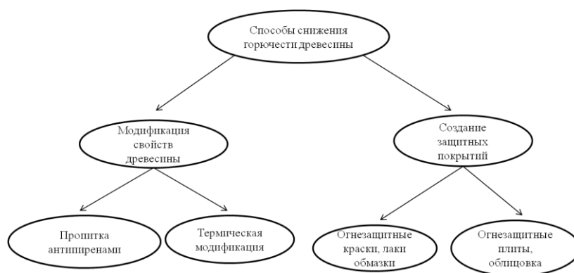
Рисунок 2 – Схема способов снижения горючести древесины
