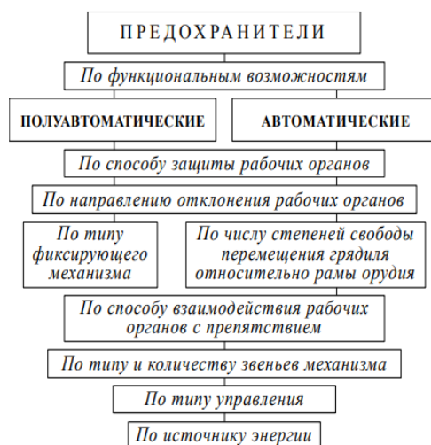
Рисунок 3 – виды предохранителей по функциональным возможностям
