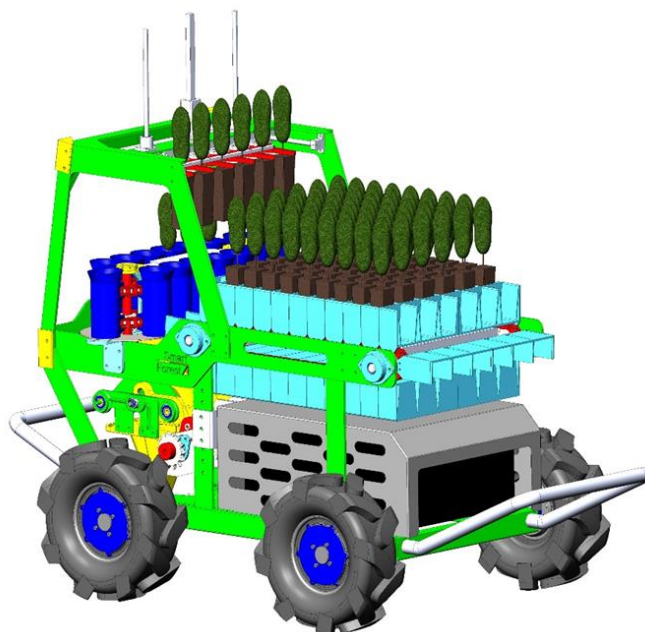
Рисунок 2 – Беспилотная наземная платформа для посадки саженце
