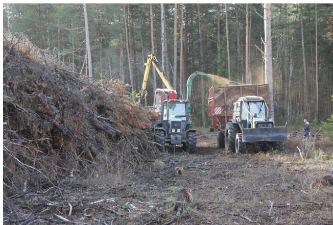
Рисунок 2 – Переработка удалённой растительности на щепу
