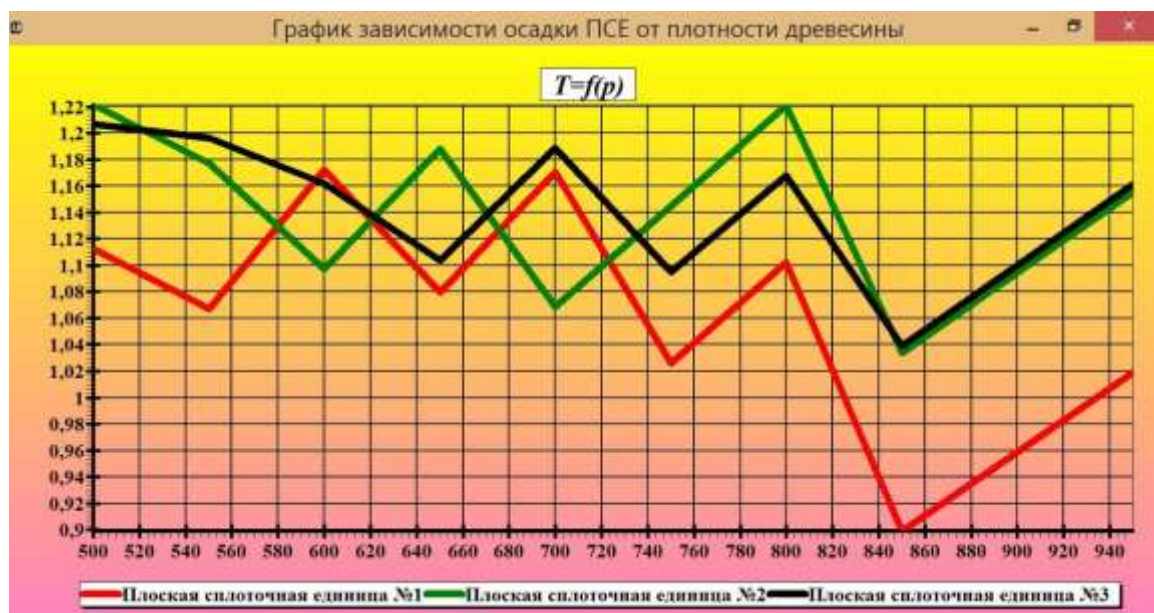
Рисунок 2 – Графики зависимости осадки плоских сплоточных единиц от плотности древесины
