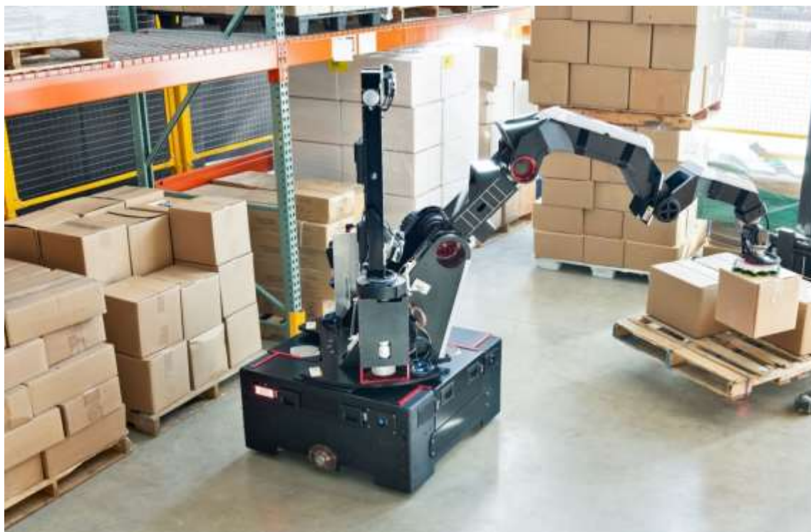
Рисунок 5 – Внешний вид робота-грузчика Stretch
