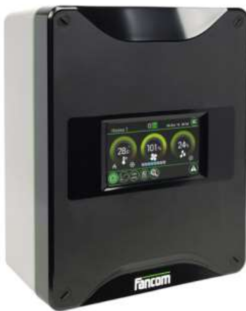
Рисунок 1 – Компьютер для управления микроклиматом
