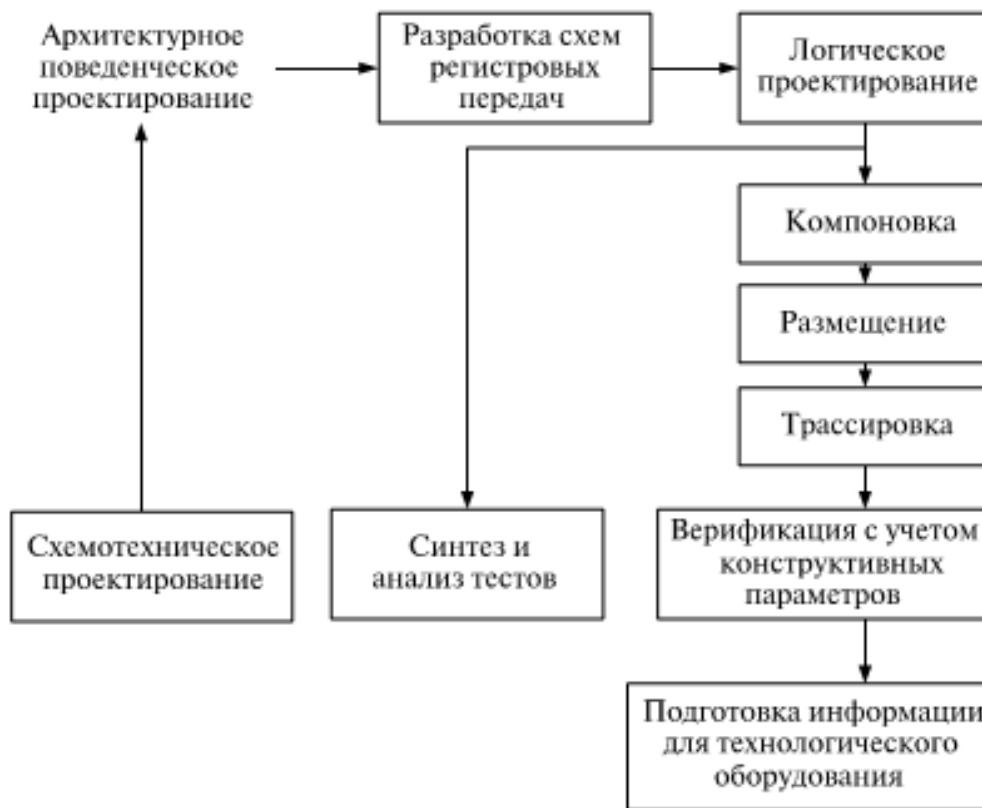
Рисунок 7 – Последовательность проектных процедур на маршруте проектирования СБИС
