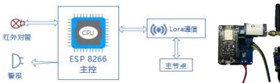
Рисунок 8 – Модуль и реальный объект для мониторинга вторжений
