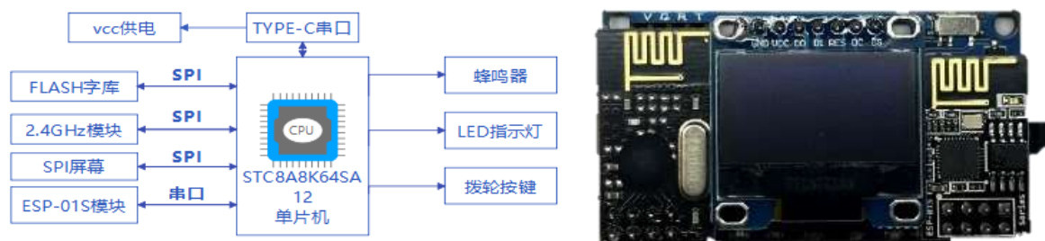
Рисунок 5 – Общая схема основной системы (слева) и реальный объект(справа)
