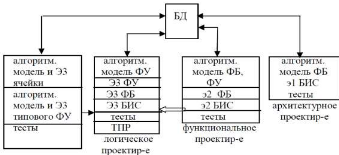
Рисунок 9 – Последовательность нисходящего проектирования
