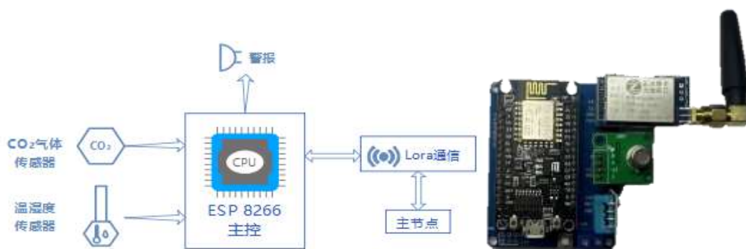
Рисунок-10 – Модуль мониторинга температуры и влажности
