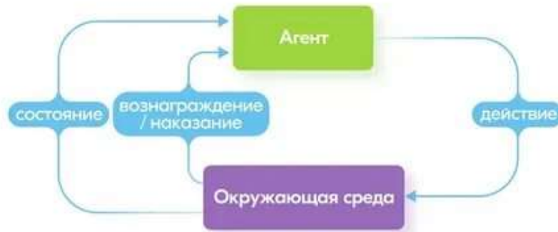
Рисунок 4 – Схема работы модели, использующей обучение с подкреплением
