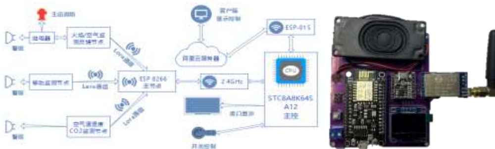
Рисунок 7 – Схема функционального сетевого подключения системы и реальный объект главного узла
