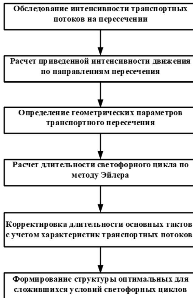
Рисунок 1 – Алгоритм определения оптимальной длительности и структуры светофорного цикла на регулируемых пересечениях с центральной разделительной полосой
