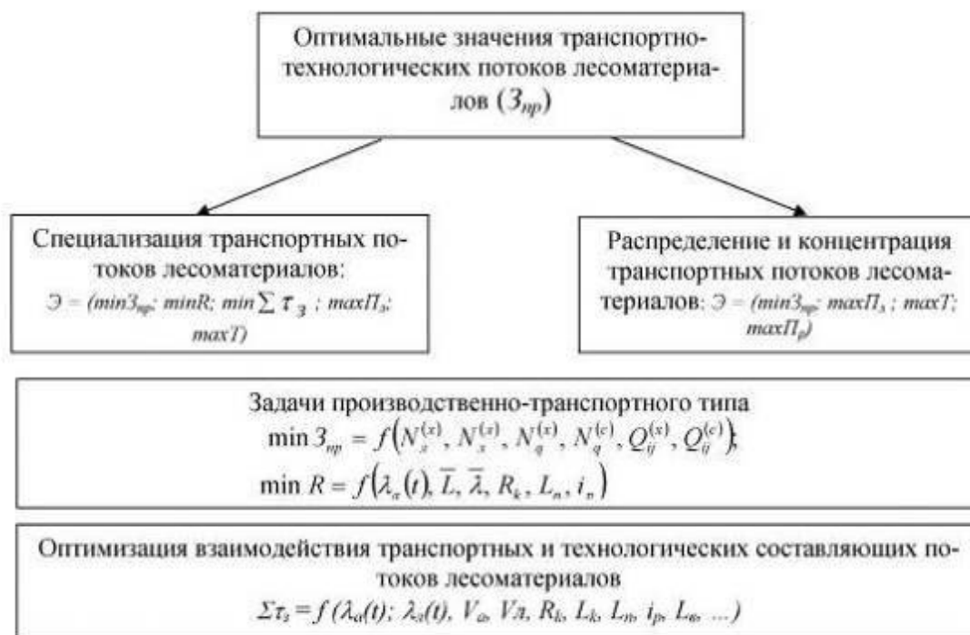
Рисунок 1 – Схема процесса совершенствования транспортно-технологических связей лесопромышленных предприятий
