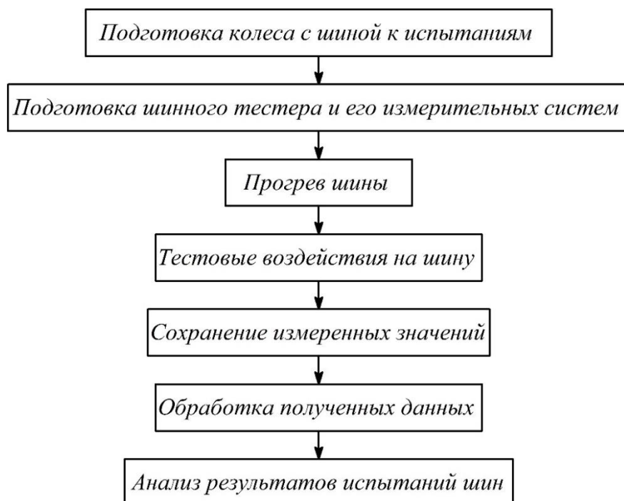
Рисунок 1 – Алгоритм методики испытания шины в режиме торможения
