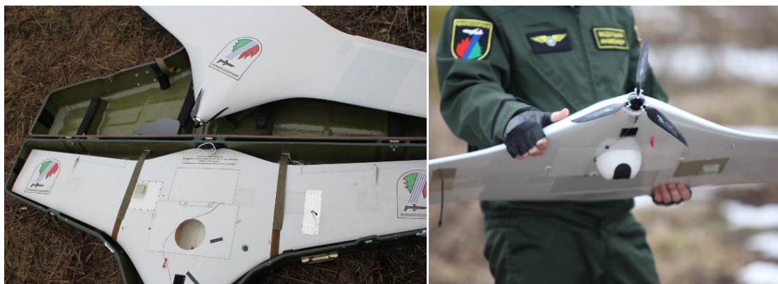
Рисунок 1 – Беспилотный летательный аппарат для мониторинга лесного хозяйства
