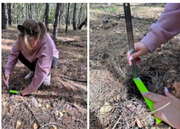
а) б) Рисунок 3 (а,б) – Процесс измерения толщины лесной подстилки
