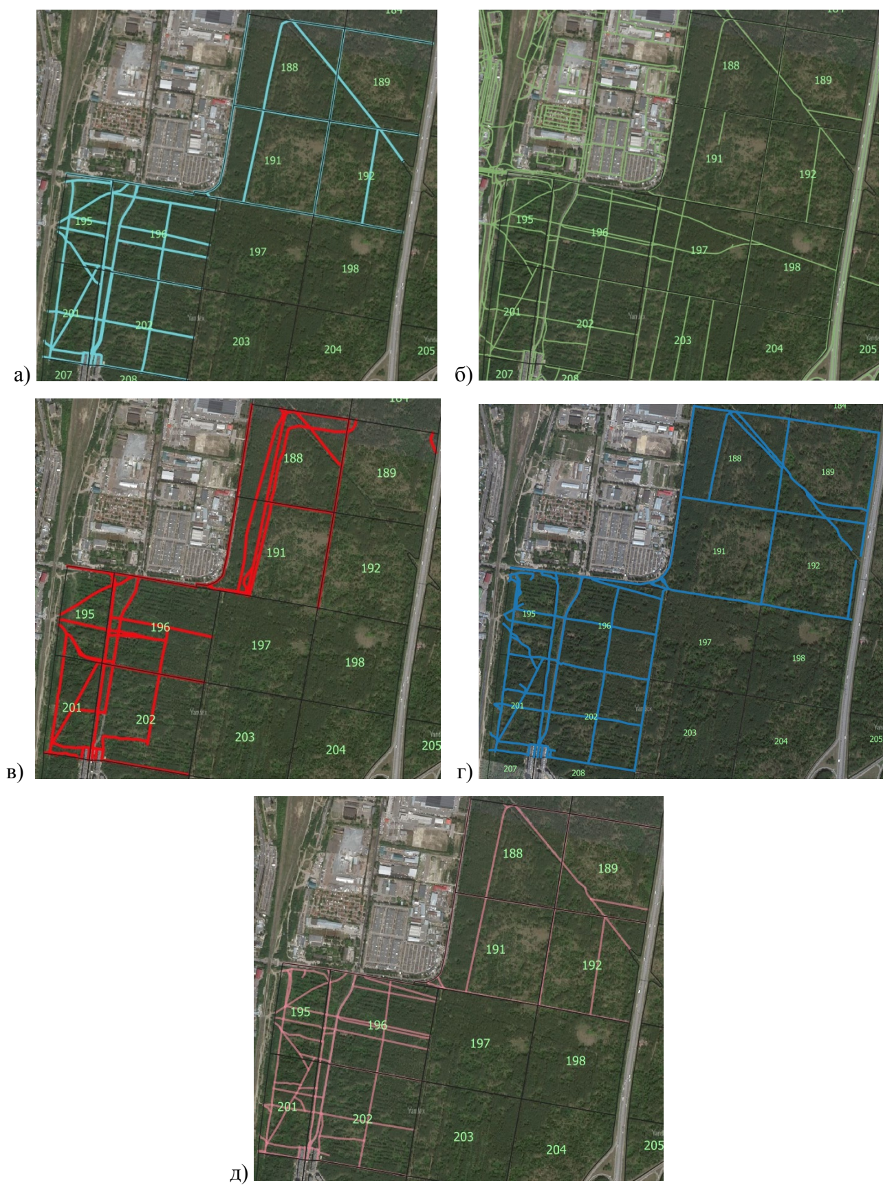
Рисунок 1 – Векторные данные расположения дорожно-тропиночной сети исследуемого объекта на основе различных источников: а) Народная карта Яндекс; б) OSM; в) GPS-трек OSM; г) космоснимок Яндекс; д) полевые исследования.
