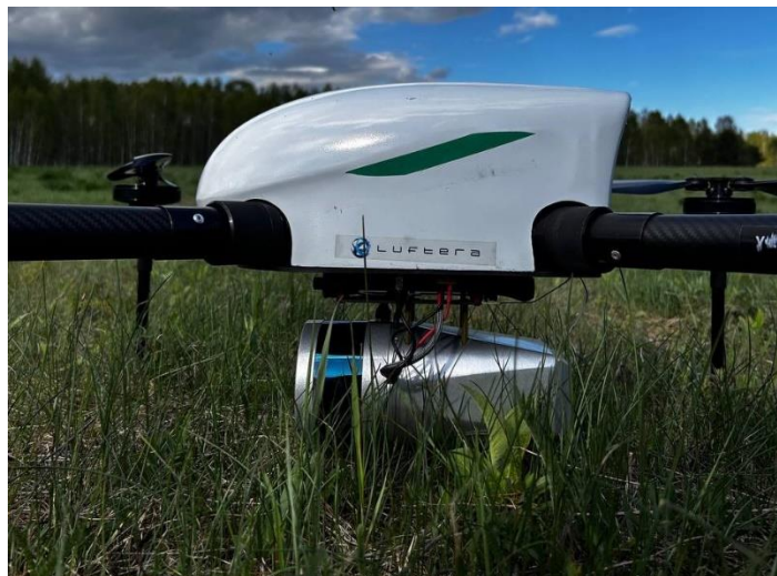
Рисунок 3 – Беспилотный летательный аппарат Luftera LQ-5 с мобильным лазерным сканером Luftera LS – 100
