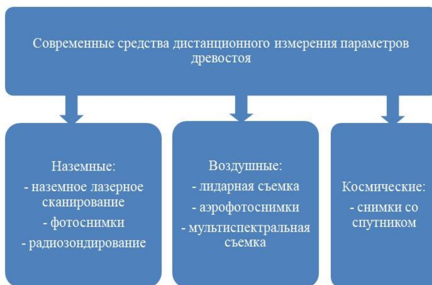
Рисунок 1 – Современные средства дистанционного измерения параметров древостоя.
