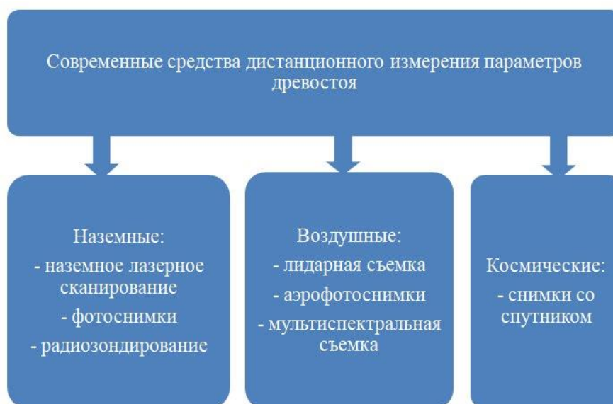
Рисунок 1 – Современные средства дистанционного измерения параметров древостоя.
