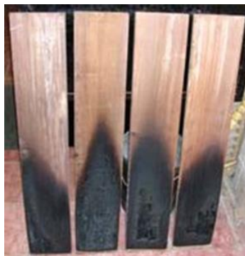
Рис. 6. Результаты огневых испытаний на горючесть образцов древесины с глубокой пропиткой составом КСД-А
