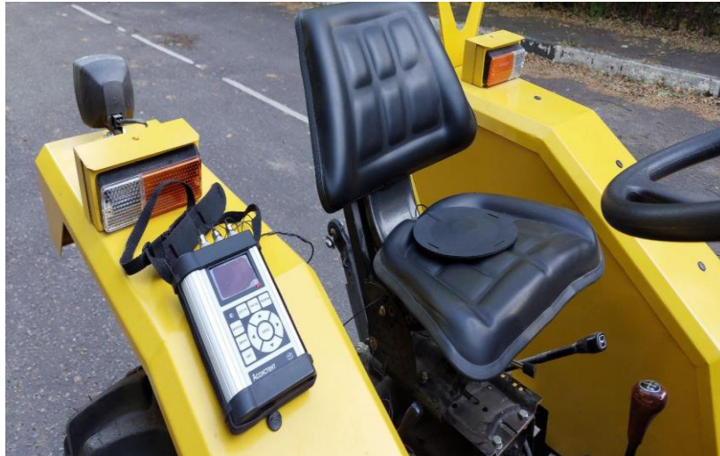
Рисунок 9 – Размещение установочного диска с интегрированным датчиком виброускорений на сиденье оператора
