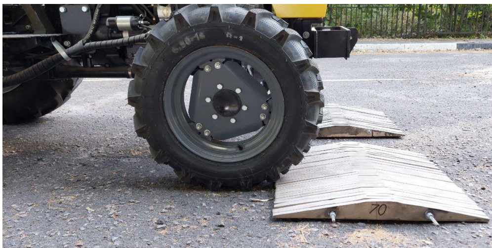
Рисунок 6 – Установка и размещение искусственных неровностей высотой 70 мм перед передней осью мини-трактора
