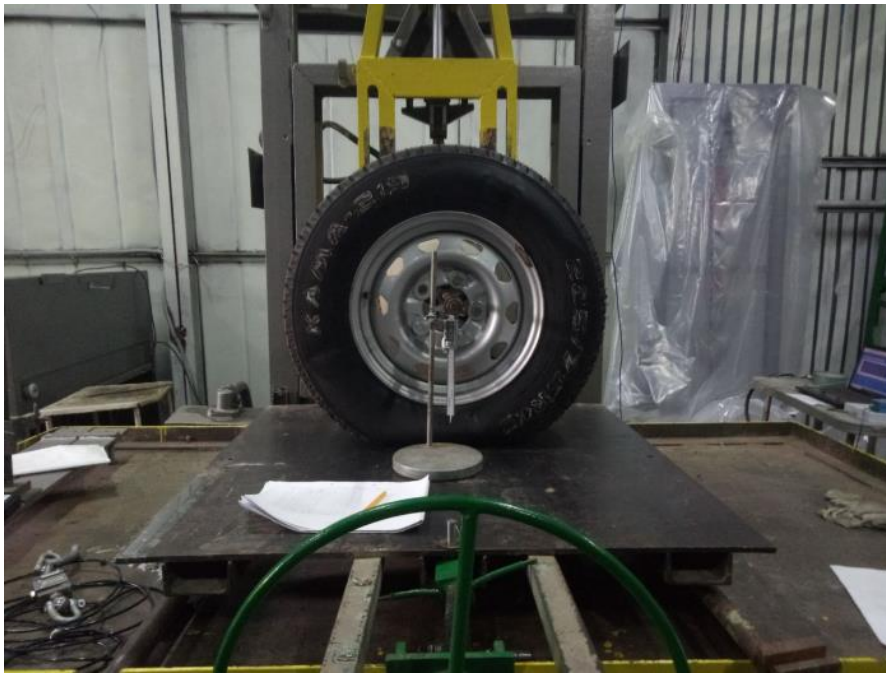
Рисунок 4 – Шина Кама-219 на стенде СИХШ 2500-1000
