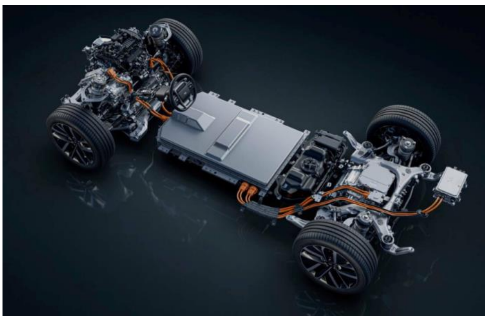
Рисунок 5 – Последовательная гибридная установка Evolute
