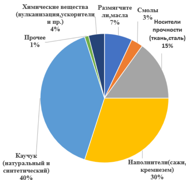
Рисунок 1 – Структура компонентов современных шин
