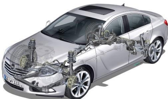
в) адаптивная подвеска автомобиля марки Opel
