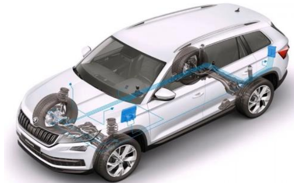
е) адаптивная подвеска автомобиля марки Skoda
