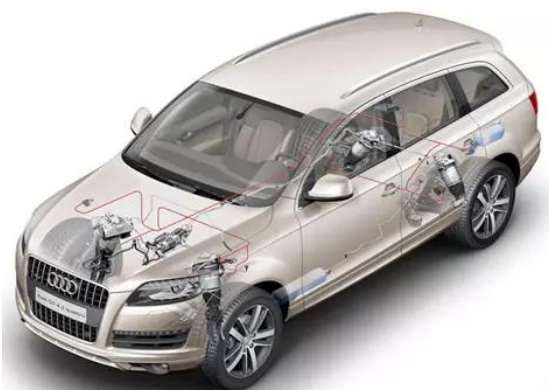
д) адаптивная подвеска автомобиля марки Audi
