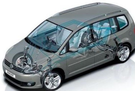
г) адаптивная подвеска автомобиля марки Volkswagen
