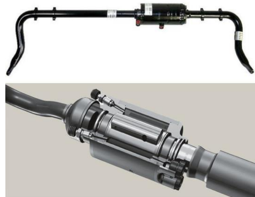
г) регулируемый стабилизатор поперечной устойчивости
