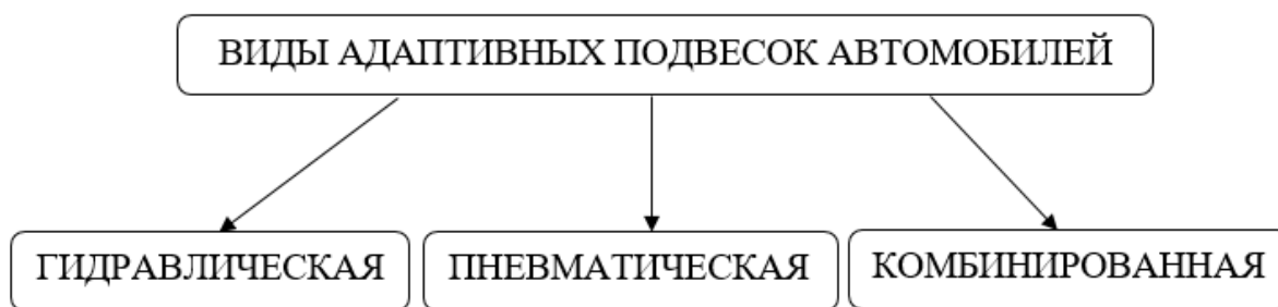
Рисунок 3 – Виды адаптивной подвески автомобиля
