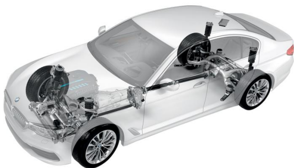
а) адаптивная подвеска автомобиля марки BMW
