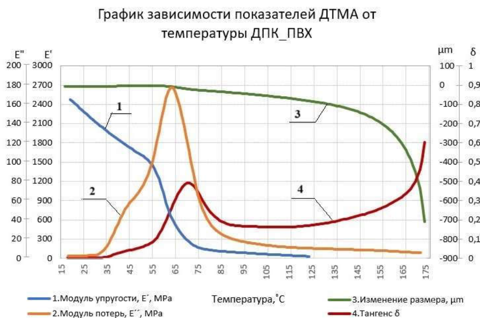
Рисунок 2 – Результаты по динамическому термомеханическому анализу древесно-поливинилхлоридного композита.
