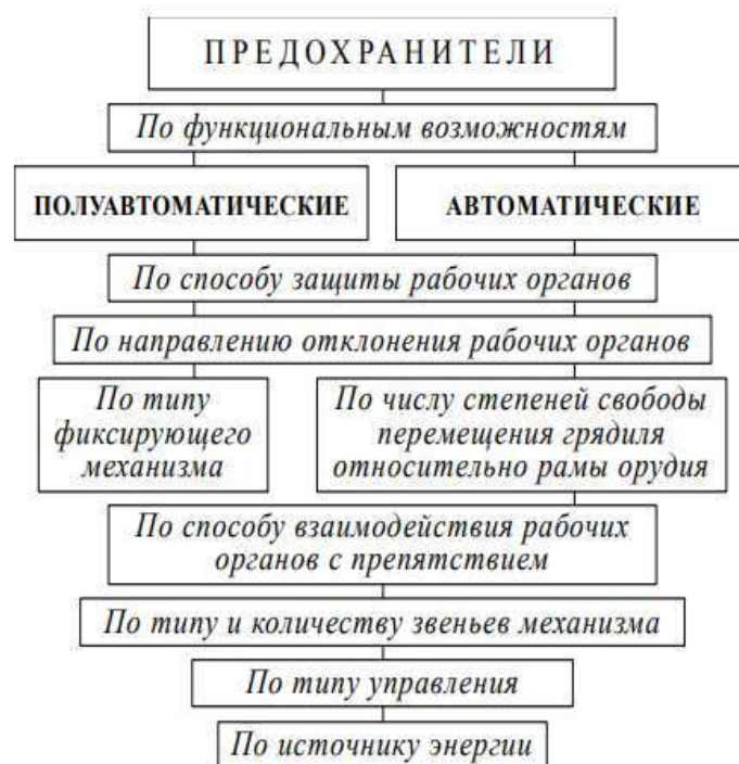
Рисунок 3 – Виды предохранителей по функциональным возможностям
