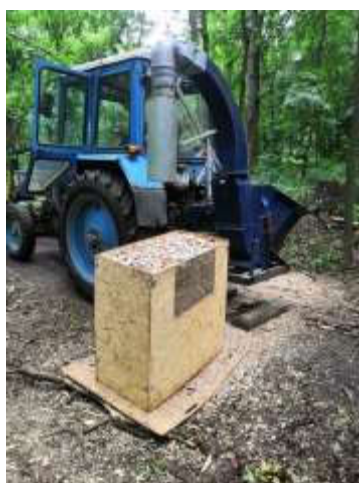
Рисунок 6 – Экспериментальные исследования измельчителя порубочных остатков
