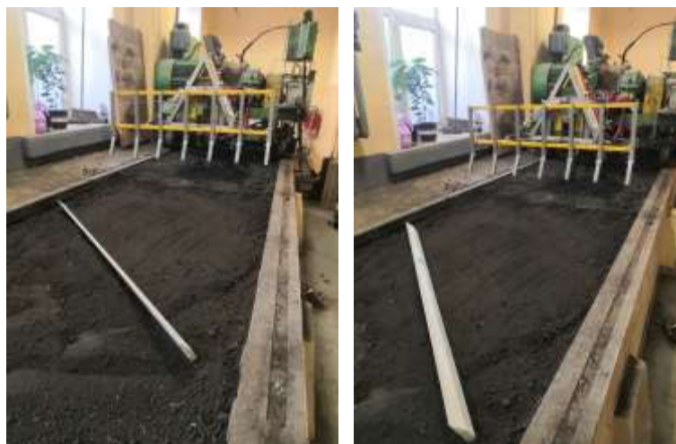
Рисунок 5 – Выравнивание поверхности почвенного канала
