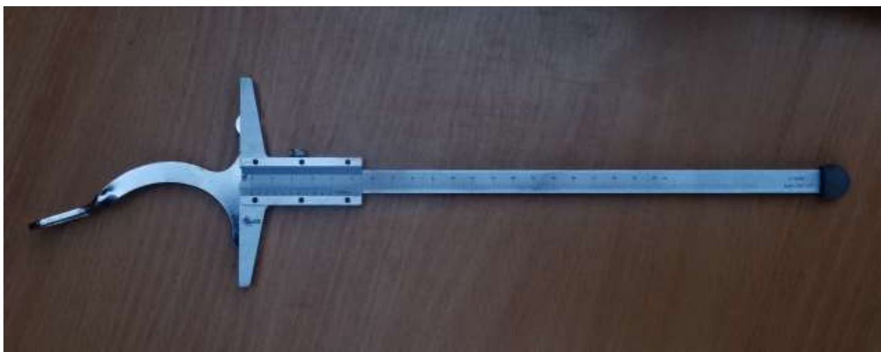
Рисунок 3 – Приспособление для контроля смещения штока гидроцилиндра
