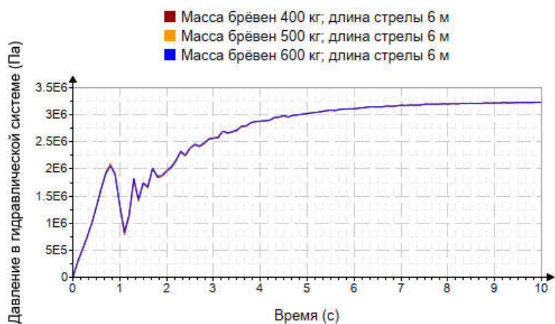
Рисунок 5 – Графики зависимости давления в гидравлической системе от времени при различных значениях массы брёвен
