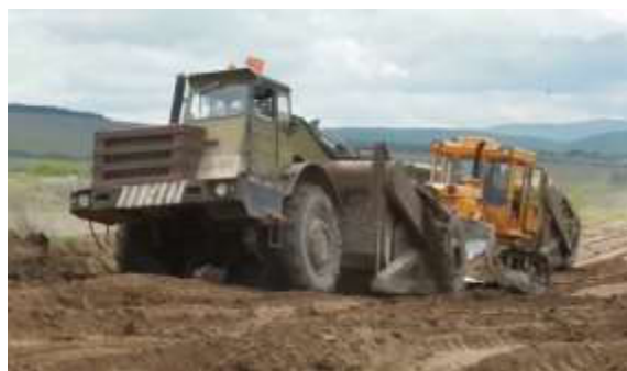
Рисунок 1 – Выполнение скрепером забора грунта с помощью вспомогательной машины-толкача
