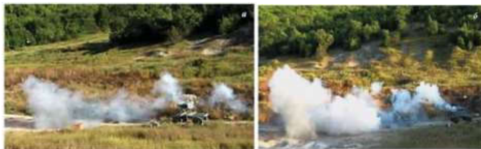
Рисунок 2 – Распыление порошка выстрелом пожаротушащего снаряда
