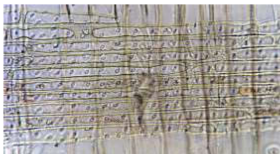
Рисунок 3 – Микроснимок радиального среза древесины образца. Сердцевинный луч с полем перекреста. Препарат не окрашен.
